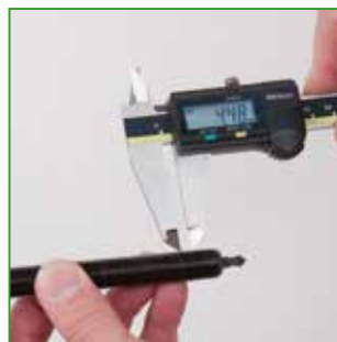
c Meet de lengte over 3 spindelgangen.
