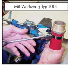
Drehen Sie den Schlauch mit der Schelle so weit nach hinten, dass der Scherhaken hinter die Schlaufe greifen kann. Lösen Sie parallel dazu die Kurbel um eine viertel bis halbe Umdrehung (je nach Schlauchtyp und -größe).
