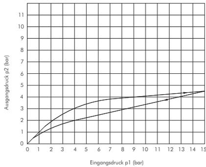
max. Durchfluss bei einem Eingangsdruck  $p_1 = 15\text{bar} = 380\text{ l/min}$
