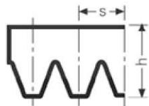
Courroies striées pour transmissions à entraxes fixes sans dispositifs de tension séparés, DIN 7867
