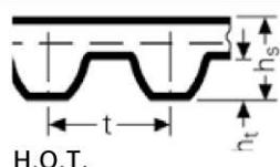
Courroie synchrone autoguidée pour applications silencieuses et à vibrations réduites; Le choix par excellence pour les transmissions horizontales
