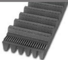
Une combinaison de courroie striée et de courroie synchrone. Appropriées aux plages de puissances faibles et moyennes en gamme standard, aux fortes puissances à hautes vitesses en gamme CXP et aux très forts couples à basses vitesses en gamme CXA. Cette courroie permet le patinage sur le coté strié en cas de surcharge.
