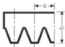
Courroies striées avec cordes de traction à faible allongement pour transmissions hautes performances soumises aux charges les plus fortes, DIN 7867
