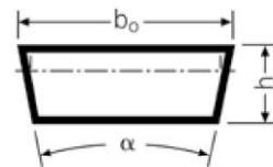
Courroies trapézoïdale large avec armature renforcée en polyester pour variateurs de vitesse
